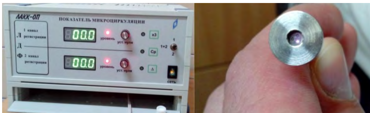
Рисунок 2 – Основной блок аппарата «ЛАКК-ОП» (слева) и встроенный световодный зонд-датчик для чрескожного исследования микроциркуляции (справа)
